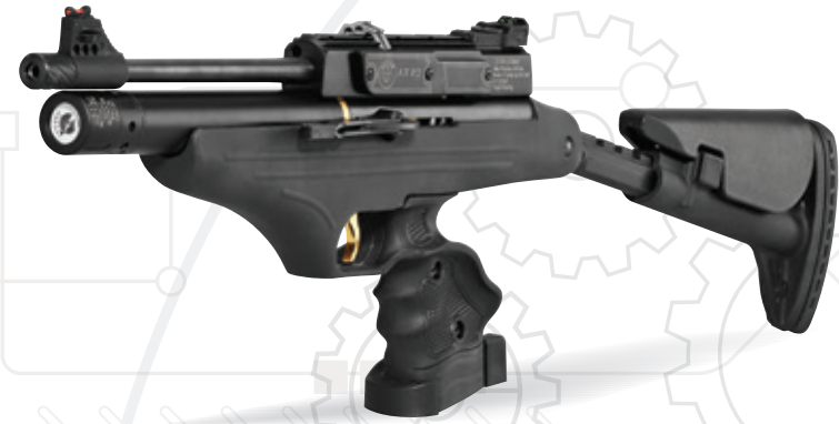
Ayarlanabilir ve sökülebilir taktik teleskopik kundak. Ayarlanabilir kundak sayesinde kundak boyu 10cm uzatılabilir. Yükseklik ayarlı yanak
